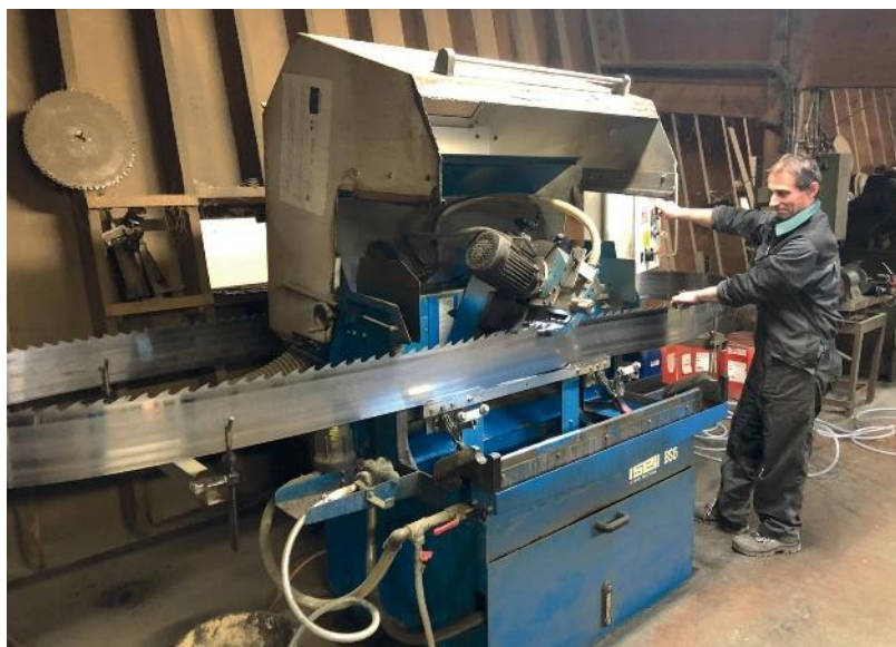
Polissage fond de dent sur affûteuse sous arrosage Iseli. Toujours dans l'optique de maîtriser l'ensemble de la production, l'entreprise possède son propre affûteur pour assurer la maintenance de l'ensemble de ses lames. SD
